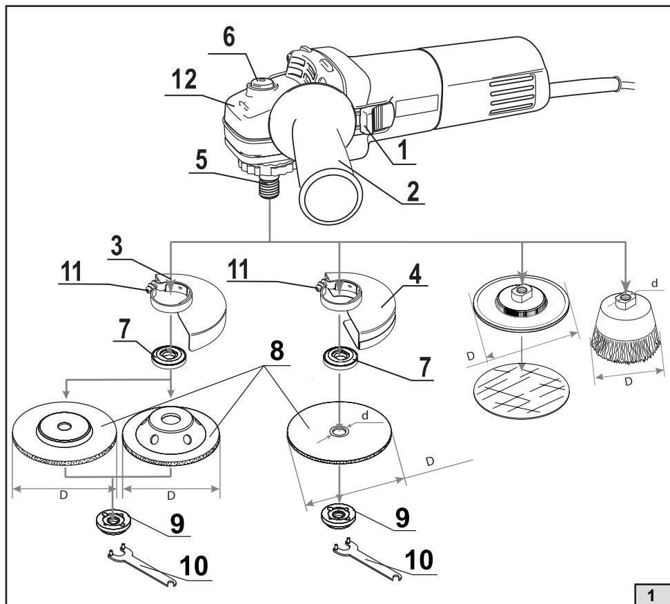
**D** - Максимальный диаметр рабочего инструмента;
